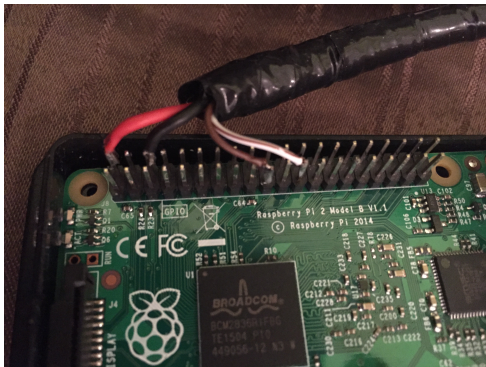
Abbildung : Fertig gelötete Anschlüsse
